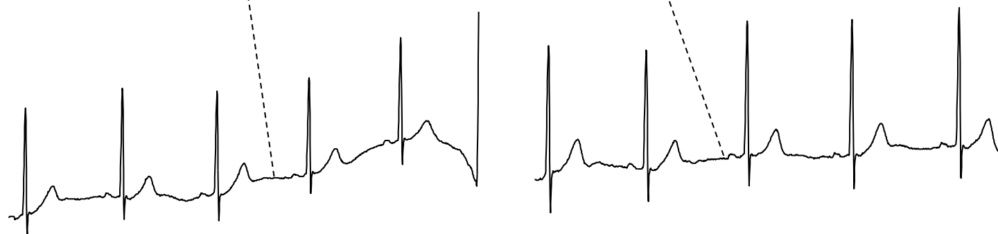
Captura de biopotenciales: tensión de offset de electrodos y artefactos.
