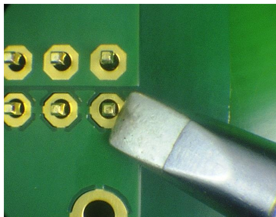
Punta para soldar demasiado grande y puede dañar la mascara antisoldante o levantar una corona
