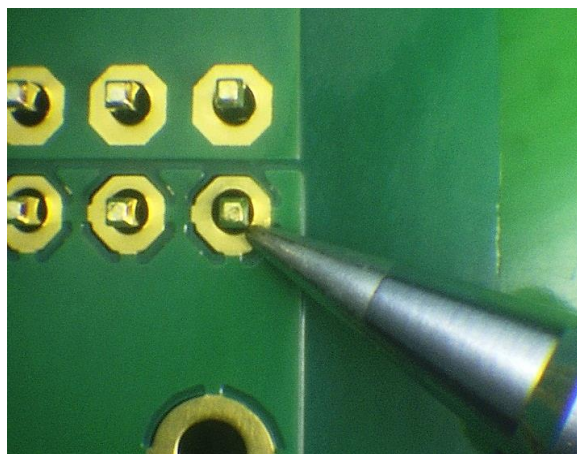
Punta para soldar demasiado pequeña (Algunas llamadas Universales y otras muy pequeñas denominadas Agujas)
