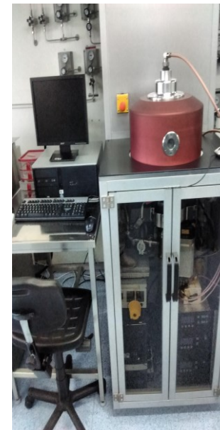
Depósito de 300nm de \text{SiN} utilizando PECVD.
