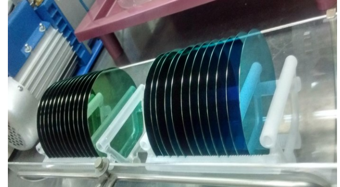
Obleas con crecimiento de \text{SiO}_2 sobre sustrato de Si mediante oxidación térmica (DES - CNEA)
