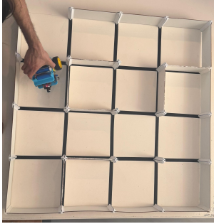
Figura 2. Laberinto implementado con paredes rebatibles.
